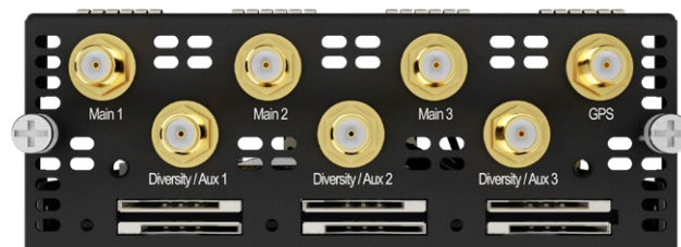
3x LTE-A Module (EXM-3LTEA)
